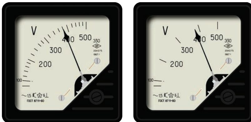
Figuur 14.2 Analoge spanningsmeters met verschillende schaalverdelingen
